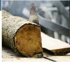
Der Baustoff besteht vor allem aus Cellulose und Lignin. Ist Holz dauerhaft Feuchte ausgesetzt, wird es leicht von Pilzen und Insekten befallen. Richtig eingesetzt ist es jedoch sehr lange haltbar. Holz weist zudem eine hohe Elastizität bei gleichzeitig hoher Stabilität und Festigkeit auf. Ebenso zählen eine gute Schalldämmung und eine schlechte Wärmeleitfähigkeit zu seinen Eigenschaften. Holz ist daher für vielfältige Verwendungen im Innen- und Außenbau attraktiv.
