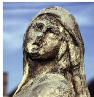
**B2** Materialschäden durch sauren Regen bei Kalkstein
