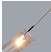
Wasserstoff kann mit der **Knallgasprobe** nachgewiesen werden. Ist Wasserstoff bzw. ein Wasserstoff-Sauerstoff-Gemisch vorhanden, so hört man einen leisen Pfeifton bzw. ein Knallen.
