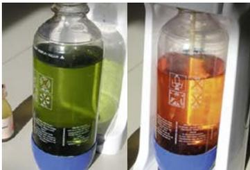
**B2** Mit Universalindikator versetztes Leitungswasser vor (links) und nach dem Einleiten von Kohlenstoffdioxid (rechts)
