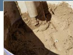
Lehm ist ein sehr vielseitiger Baustoff, der bereits seit vielen Jahrtausenden eingesetzt wird. Lehm ist z. B. nicht brennbar, schalldämmend, hat ein gutes Wärmespeichervermögen und eine hohe Bindefähigkeit für Schadstoffe, Gerüche und Wasser.
