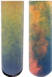
**B1** Farbwechsel des Universalindikators bei Zugabe einer sauren Lösung zu einer basischen Lösung
