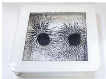
Das magnetische Feld von Permanentmagneten lässt sich auch mit Eisenfeilspänen untersuchen, die um den Magneten herum gestreut werden, oder mit vielen Magnetnadeln, die dazu oftmals
