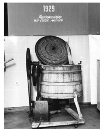
**B3** Eine der ersten Waschmaschinen mit elektrischem Antrieb aus dem Jahr 1929.
