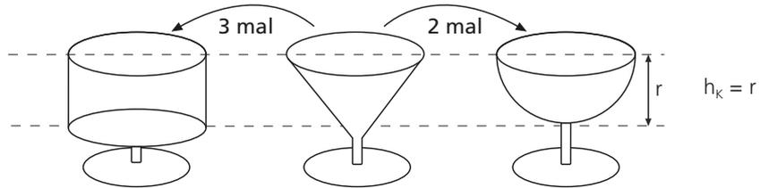
$$V_{\text{Zylinder}} = 3 \cdot V_{\text{Kegel}}$$
