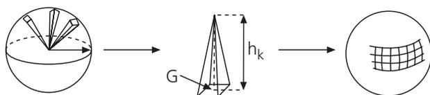
$$V_{\text{Kugel}} = \frac{1}{3} \cdot (G + G + G + \dots + G) \cdot h_k$$
