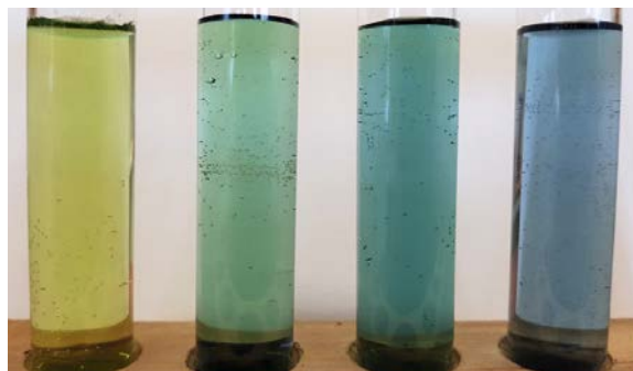
B6 Der Universalindikator zeigt die unterschiedliche Basizität der wässrigen Lösungen von Anilin (links), Ammoniak (mitte) und Methylamin (rechts). Die Wasserabblutung (ganz links) dient als Blindprobe.
