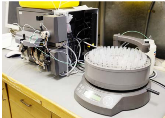
B3 HPLC-Apparatur (links) mit automatischem Fraktions-sammler (rechts).
