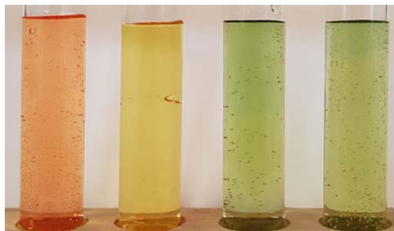
B2 Der Universalindikator zeigt die unterschiedliche Acidität der wässrigen Lösungen von Ethansäure (links), Phenol (zweites von links) und Ethanol (zweites von rechts). Die Wasserprobe (rechts) dient als Blindprobe.
