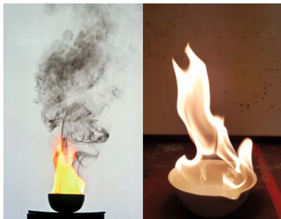
B1 Verbrennung von Benzol (links) und Hexan (rechts)
