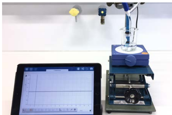
B1 Eine Messsonde ist über Bluetooth mit der Messwerterfassungssoftware verbunden.
