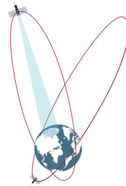
**B2** Bahnen von Satelliten in „Highly Elliptical Orbits“ (Arbeitsauftrag 4)
