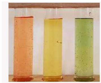
**B2** Universalindikator mit gleich konzentrierten wässrigen Lösungen von Ethansäure (links,  $pK_S = 4,75$ ), Phenol (Mitte,  $pK_S = 9,99$ ) und Ethanol (rechts,  $pK_S = 16$ )
