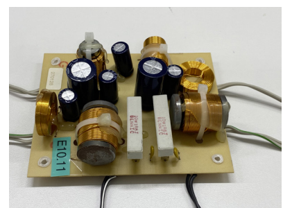
B8 | Links: RL-Glied und RC-Glied parallelgeschaltet; Rechts: Anordnung in der Realität.
