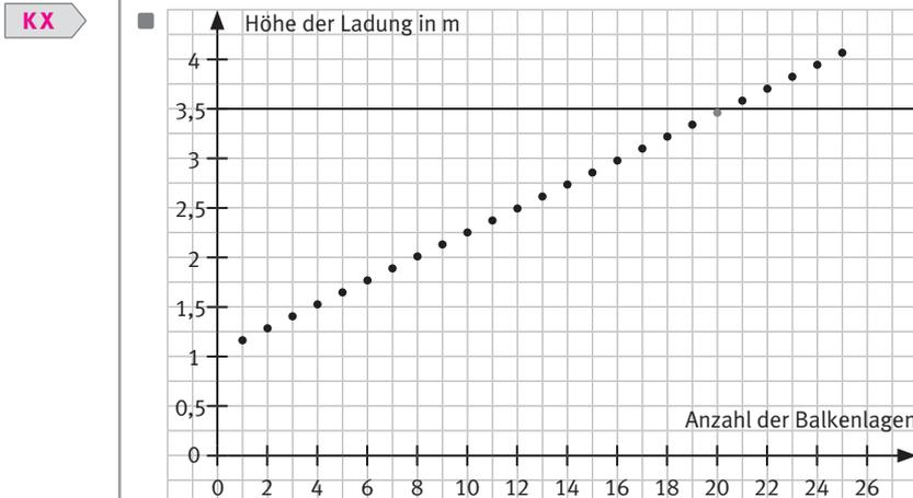
Der grau markierte Punkt zeigt die Lösung: Es können maximal 20 Lagen Balken auf den Lkw gestapelt werden.
