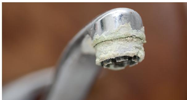
**B2** Im Gegensatz zu Tropfsteinen bilden sich die Kalkablagerungen an Haushaltsgeräten schnell. **A:** Erläutern Sie anhand der Gleichgewichtsreaktionen auf S. 121, warum Warm- und Kaltwasserhähne unterschiedlich schnell verkalken.
