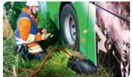
Abb. 7: Einsatz eines Hebekissens durch die Feuerwehr
