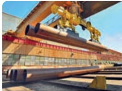
Abb. 2: Brückenkran
