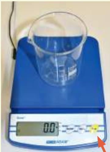
B2 Tara-Funktion einer Waage
