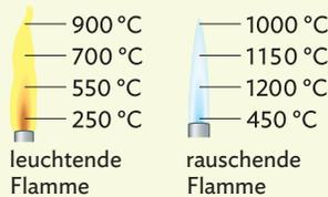
**B1** Leuchtende Brennerflamme (links) und rauschende Brennerflamme (rechts) sowie Flammentemperaturen
