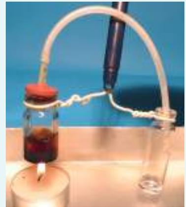
**B1** Einfache Destillationsapparatur
