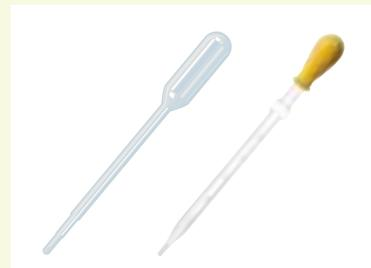
**B4** Einwegpipette (links) und Pipette mit aufgestecktem Gummisauger (rechts)
