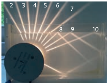
B5 | Lichtquelle unter Wasser: Brechung und Reflexion.
