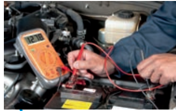
B1 Funktionsüberprüfung einer Autobatterie vor dem Winter.
